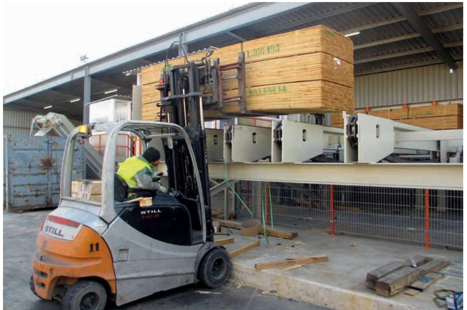
Durch den Querförderer mit integrierten Kufen können mehrere Pakete hintereinander aufgegeben werden. Das optimiert den Kappprozess | By means of the cross conveyor with integrated skids, several packages can be loaded. This optimizes the process
