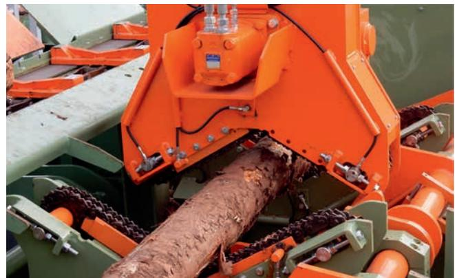
Большинство сортиментов проходит напрямую через CAMBIO на сортировочную бревнотаску с системой измерения Jörg 3D и 22 карманами. После сортировочного транспортера сортименты в зависимости от программы распила по поперечному транспортеру передаются в лесопильный цех. Толстомеры сбрасываются и окашиваются с помощью одной из новых окорок Baljer & Zembrod перед тем как их отсортировывают в соответствующий карман.
