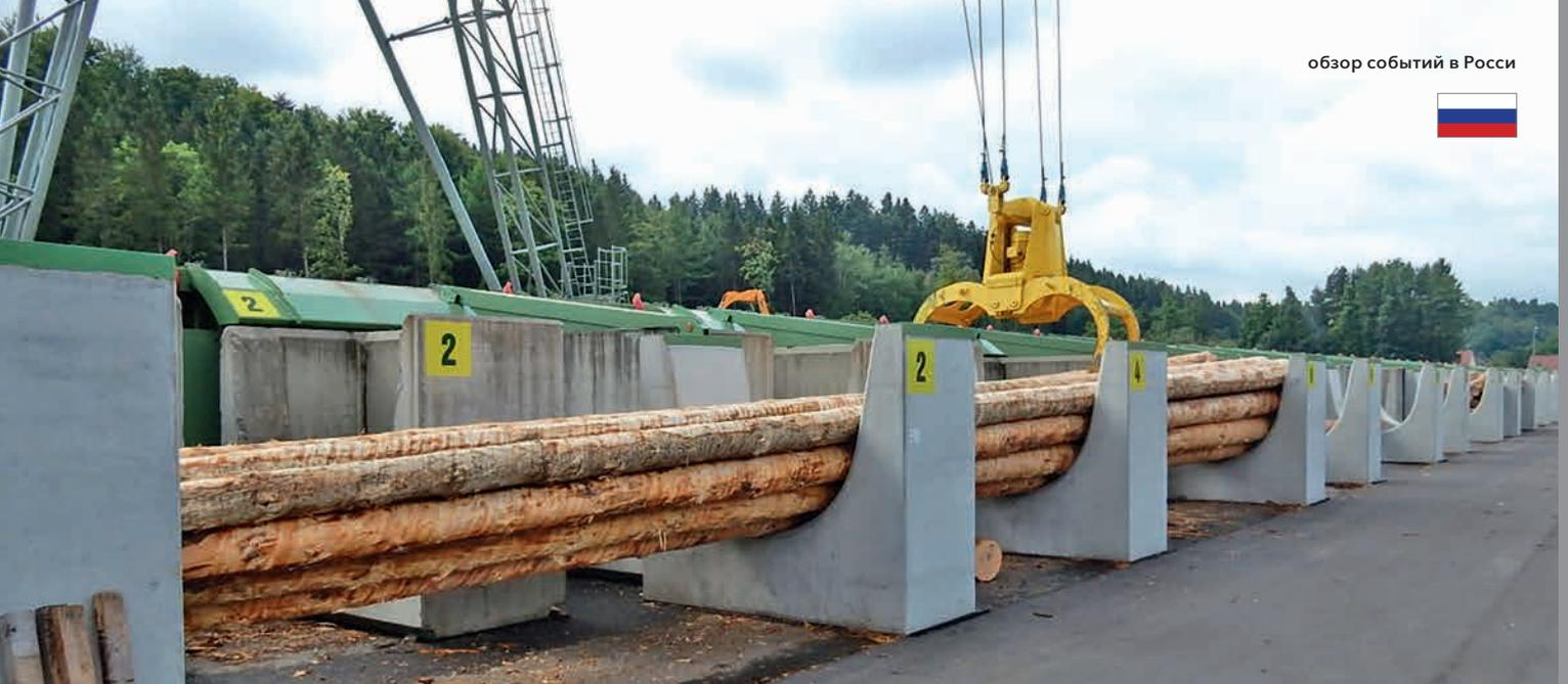
Бетонные карманы и сортировочный транспортер
