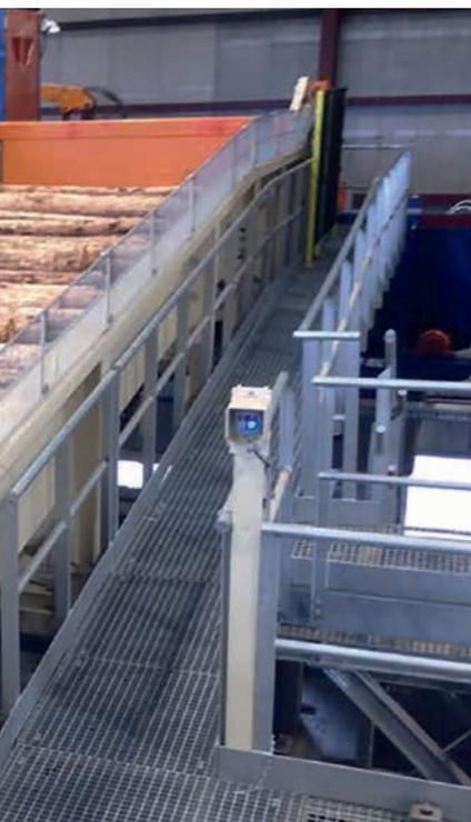
Транспортировка щепа стала в исполнении Holtec абсолютно исключительной: Двойной цепной транспортер был смонтирован на головокружильной высоте. Приводная станция главного транспортера взмывает на высоту 35м. На транспортерах были установлены специальные цепи из Канады, которые положительно зарекомендовали себя еще на заводе Norbord в Генк. Там Holtec уже несколько лет последовательно переводил оборудование на „Канадский стандарт“.
