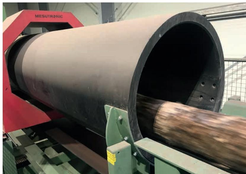
Dickwandiges PE Rohr statt anfälliger Holzkonstruktion
