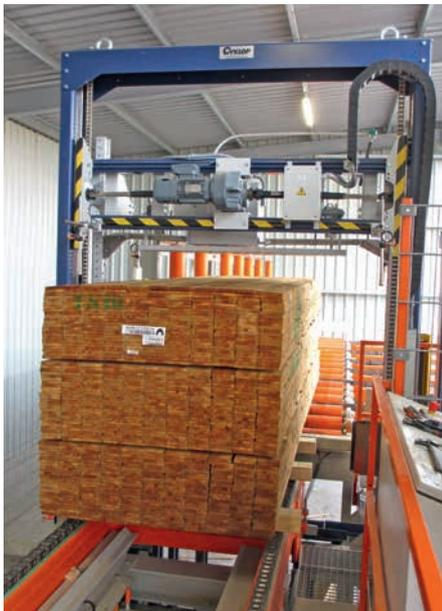
Vollautomatisches Umreifen mit der Cyklop Bindeanlage | Fully automatic strapping with the Cyklop binding system
