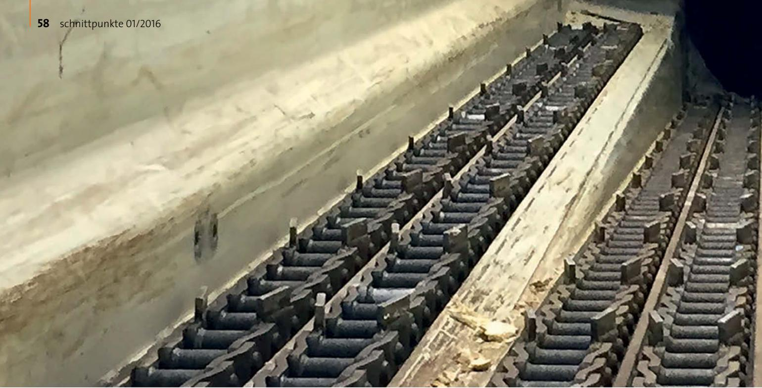
Massiver Kettenbettförderer zur Beschickung des Scheibenhackers.
