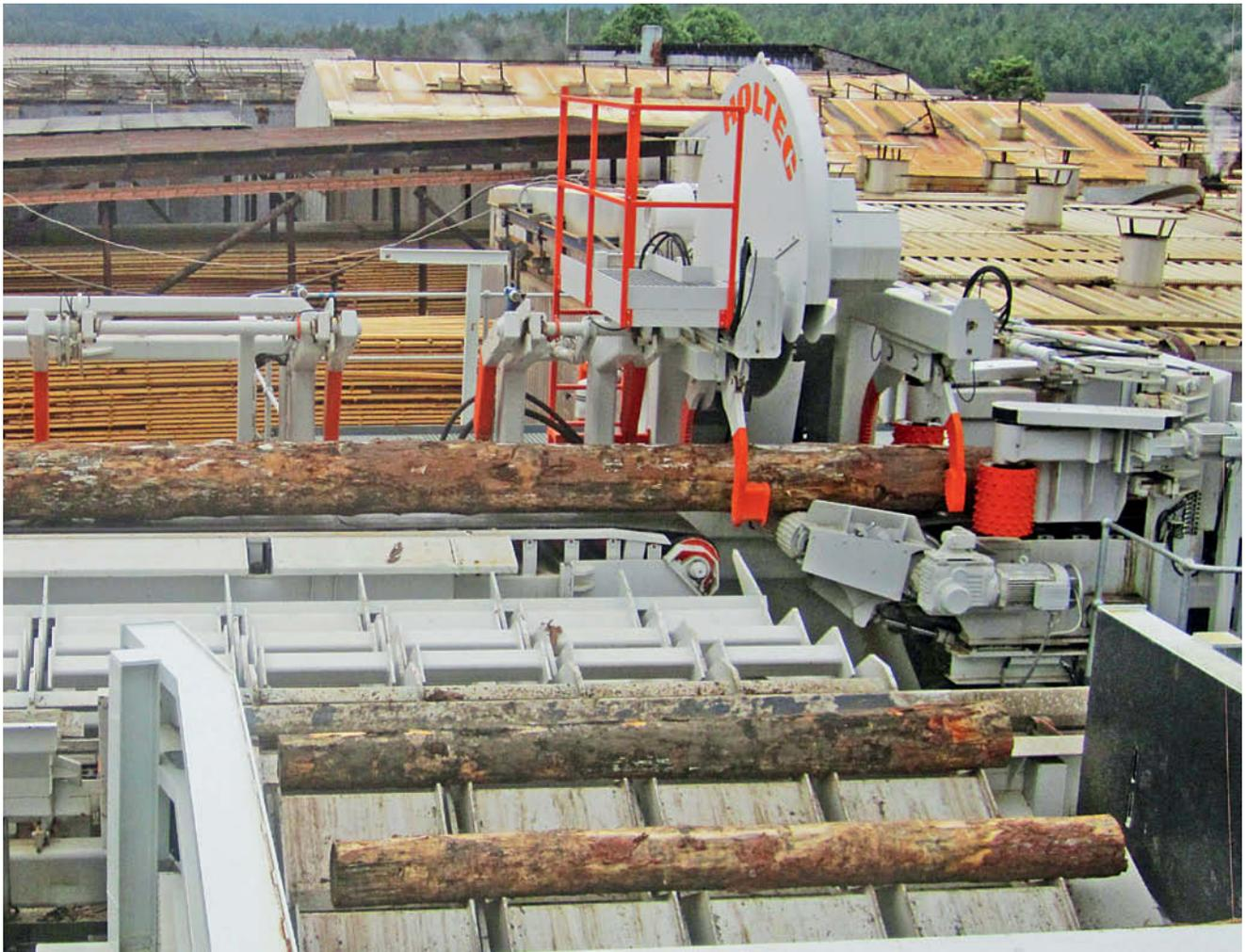
Die mit dem bewährten Längenanschlagstisch produzierten Abschnitte werden parallel zur Kurzholzaufgabe auf den Beschleunigungsblockzug aufgegeben. The short logs, produced by the proven length stopper table are fed to the accelerating chain conveyor parallel to the short log infeed.
