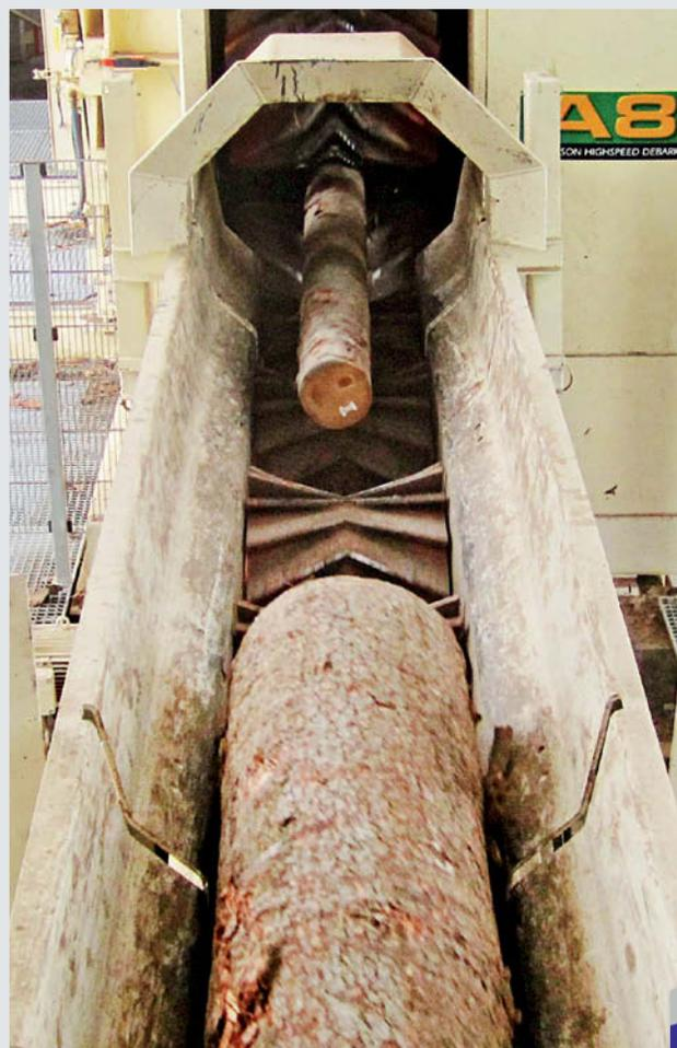
Подача в окорочный станок Nicholson модель A8 осуществляется с помощью поднимающихся и опускающихся роликов Holtes. Межторцевое расстояние и уровень наполнения транспортера регулируются системой garcontrol™. Таким образом осуществляется оптимальная подача в окорочный станок.
