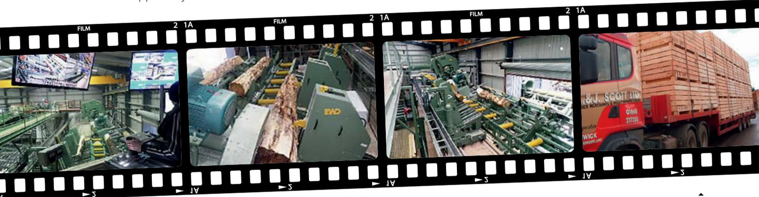
Neue Sägelinie EWD mit geneigter Blockbandsäge.
