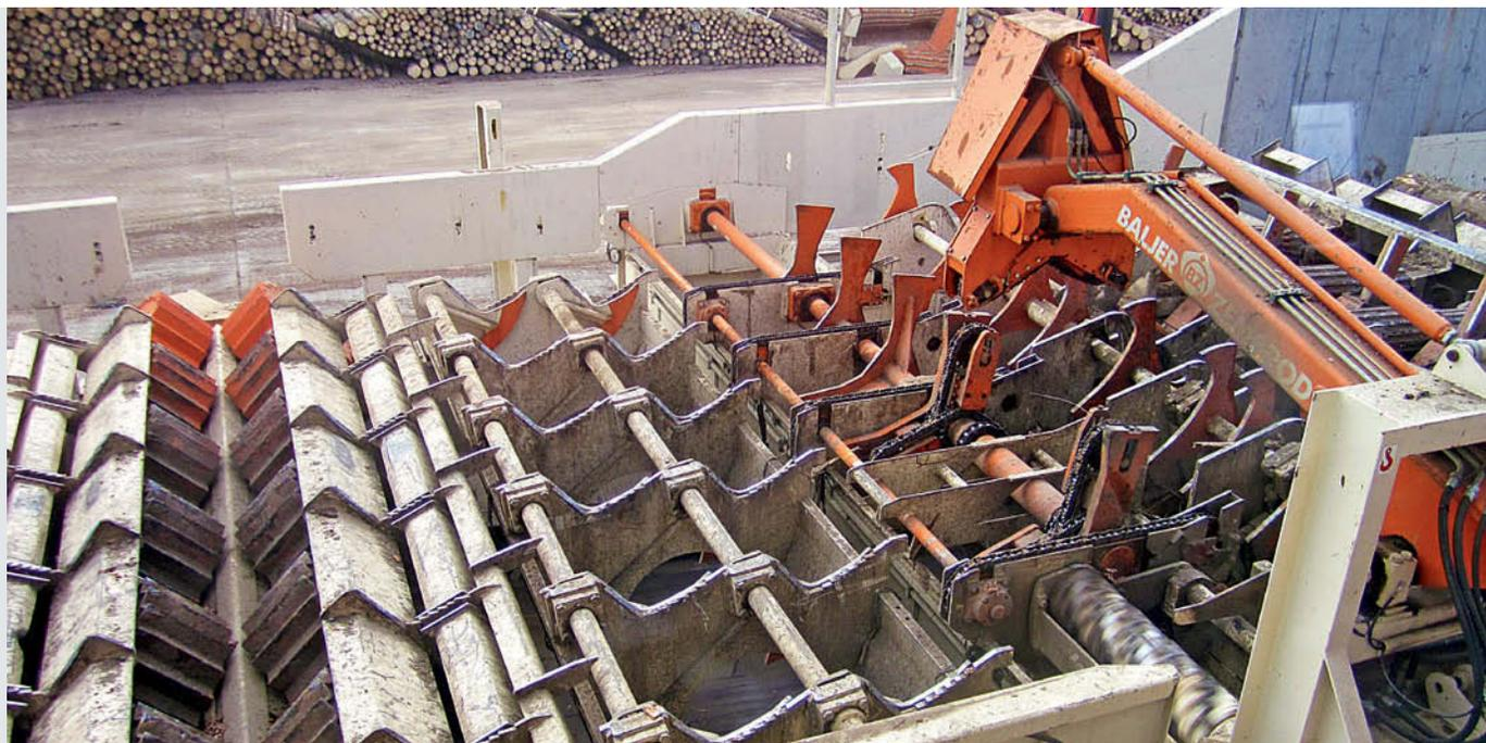
В систему подачи chainless™ встроен высокопроизводительный комлеобрезчик типа STAR
