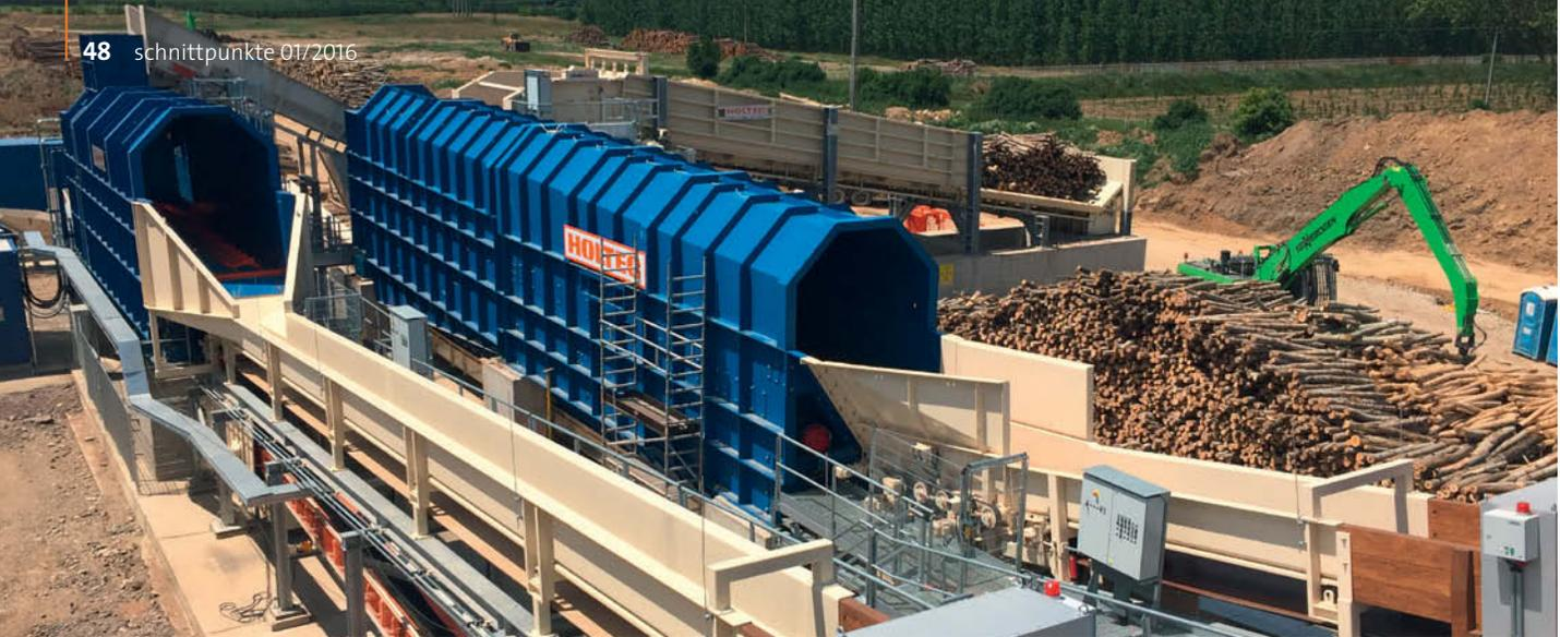
▲ Blick auf die beiden Entrindungslinien - links im Bild die Kurzholz-Entrindung als Ein-Sektionen-Maschine
