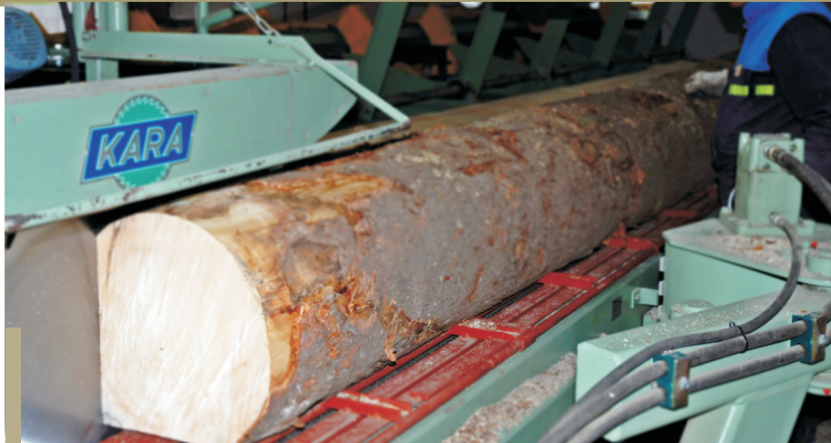
Ważną cechą jest duża elastyczność traka KARA F200, gdyż wymiar cięcia można zmienić każdorazowo w szybki sposób przed każdym „przelotem” kłody
