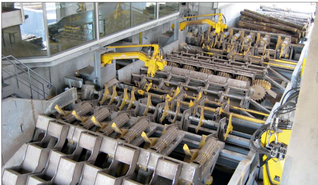
„Chain-less“-Beschickungssysteme in der Sortierlinie des Sägewerks Brilon
