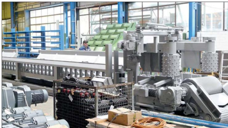
Im Vordergrund eine Beschickung, im Hintergrund ein Stufenschieber
