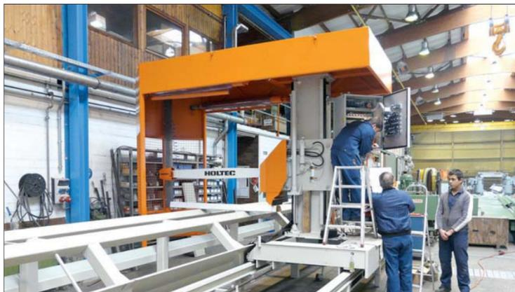
Serienprodukt: Schnittholz-Paketkappanlage in der Montage
