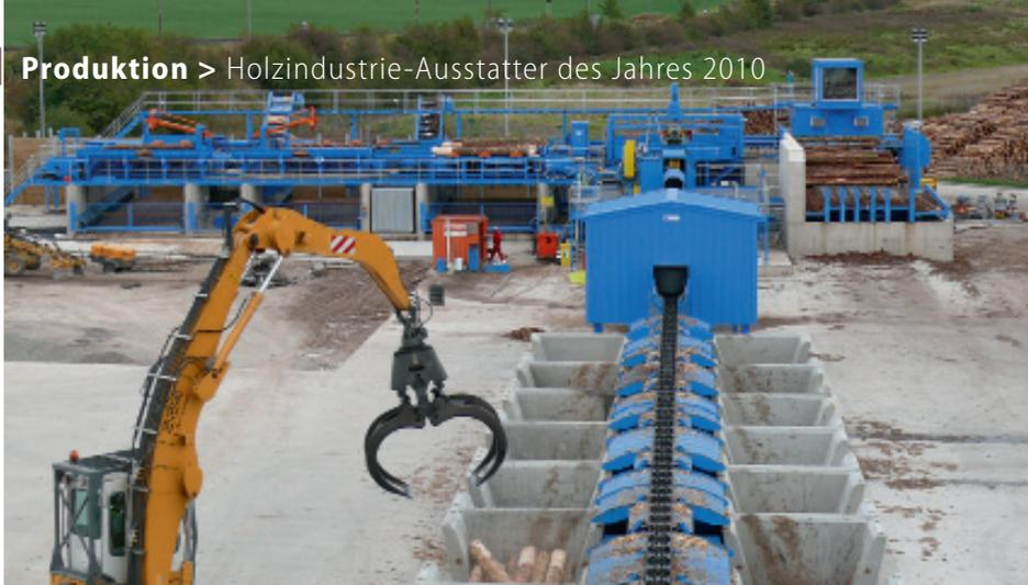
**Rundholzsortierung bei James Jones:** Rundholzplatz mit zwei Reduzierbypässe (hinten links), Drehvorrichtung, Entrindung und Mess- und Sortierblockzug
