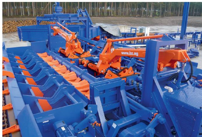
WRP-Star-Doppelwellenreduzierer mit Mechanisierung von Holtec bei James Callander in Schottland
