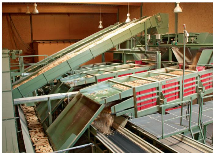
Das Hackgut (vorne) wird in drei Fraktionen, die Späne werden in zwei Fraktionen separiert
