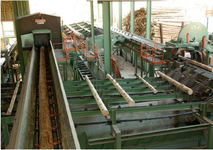
**Das Langholz bis 22 m** wird vermessen und entsprechend der Sondersortimente gekappt
