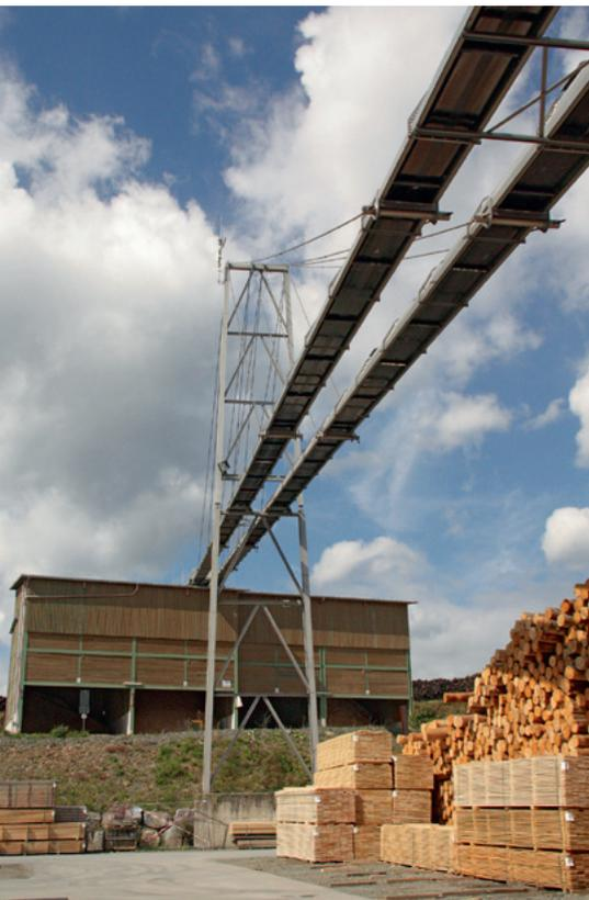
Über Rohrgurtförderer Typ RE-RGF gelangen Hackgut und Sägespäne getrennt in die Bunker
