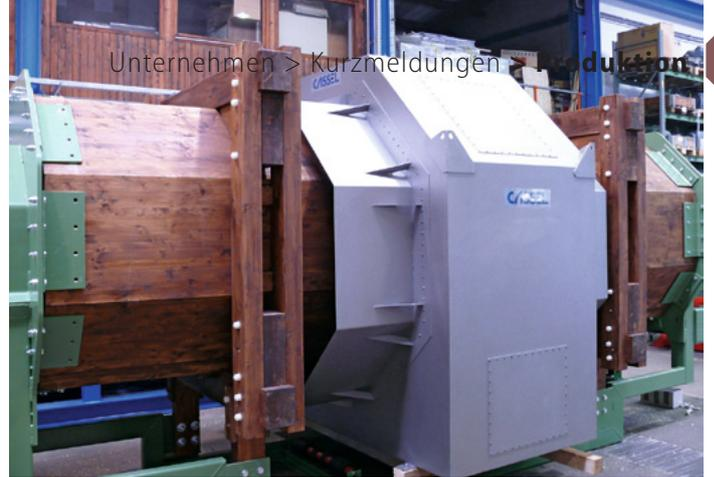
Förderband mit integrierter Metallsuchspule vor der Auslieferung bei Holtec, Hellenthal/DE
